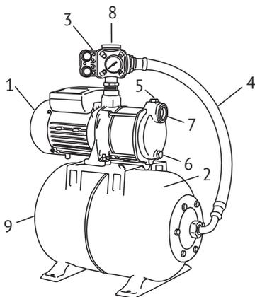
Станция состоит из следующих основных узлов – многоступенчатого электронасоса (1), гидроаккумулятора (2), блока автоматики, объединяющего реле давления и манометр (3) и соединительного шланга (4).
