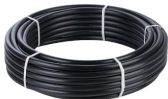
Труба из полиэтилена низкого давления (ПНД-труба) используется при монтаже систем водоснабжения, в том числе для транспортировки воды хозяйственно-питьевого назначения, а также других жидких и газообразных веществ. Температура перекачиваемой жидкости - 0...+40 °С.
