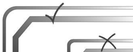
Рисунок 8 – Все изгибы должны иметь плавный переход
