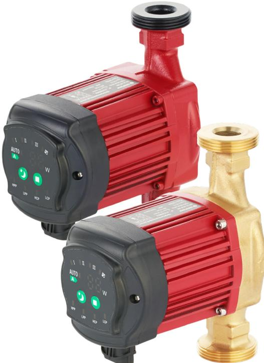
LPA – энергоэффективный циркуляционный насос с «мокрым» ротором и электронным блоком управления для систем радиаторного отопления, водяного теплого пола с постоянным или переменным расходом теплоносителя и систем горячего водоснабжения. Оснащён частотным преобразователем, который позволяет задавать различные режимы работы, обеспечивая настройку рабочих параметров в соответствии с потребностями системы.
